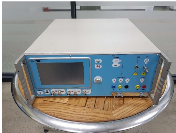
서지 발생기 (Surge generator)
