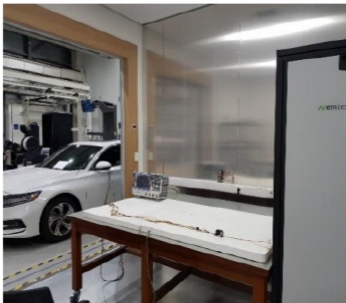
전기·전자장치 부품 전원선의 과도 전도 내성 시험
